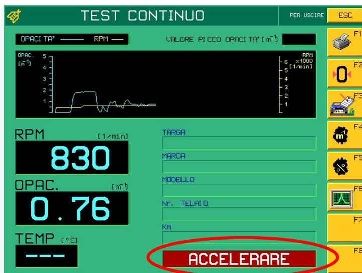
Al termine dell'accelerata il valore di picco misurato comparirà nella finestra in alto a destra dello schermo
