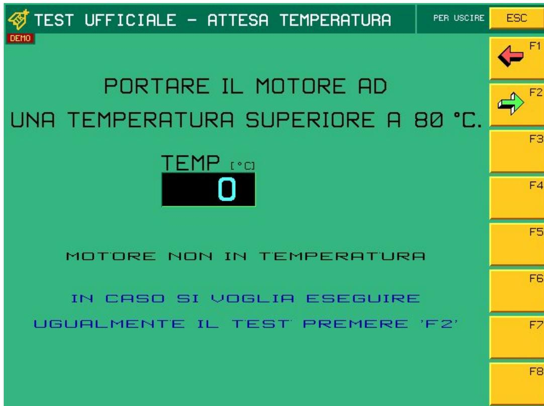
A questo punto del test di deve attendere il riscaldamento del motore secondo le prescrizioni del costruttore oppure in assenza di queste occorre proseguire nel test quando la temperatura supera gli 80 gradi.
