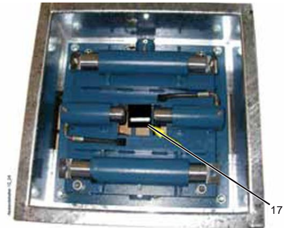
17 Position des Abstandshalters (z.b. Holzklotz ca. 100-130mm breit)
